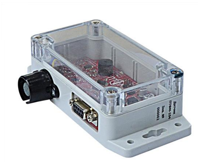
Рисунок 1.2 – Внешний вид датчиков газоанализатора
